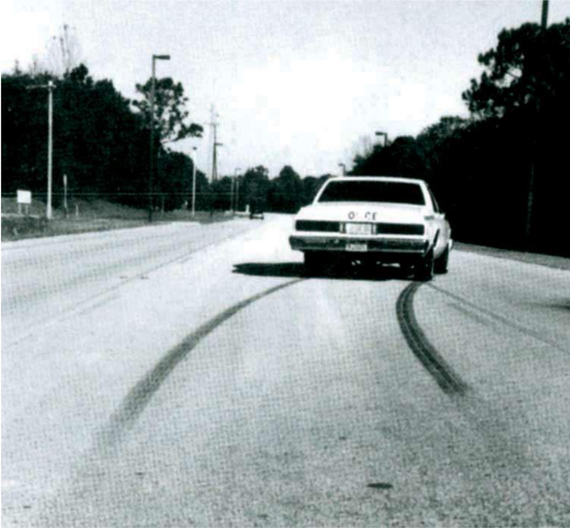
En la presente se puede apreciar la trayectoria seguida por un rodado donde sólo trabajan el freno delantero derecho y el trasero izquierdo, el desvío hacia la derecha es causado por el mayor frenado de la rueda delantera derecha producto de la traslación de pesos.
