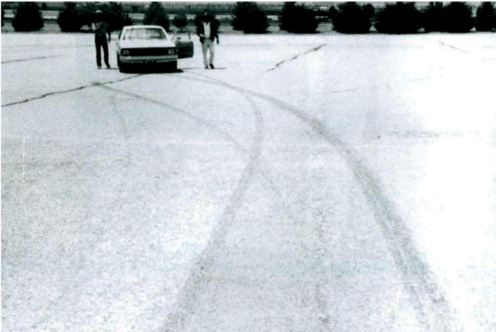
Muestra un "spin out" típico, causado por el bloqueo de las ruedas traseras sin bloqueo de las delanteras
