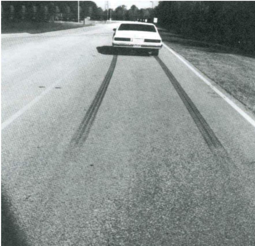
La marca de bloqueo sobre la calzada se origina debido al calor localizado en una pequeña superficie de la cubierta (la que está en contacto con la calzada) lo que provoca el ablandamiento del material de la cubierta, el que, al desprenderse, marca el pavimento. La marca que se observa es lo que en adelante llamaremos huella o marca de bloqueo (**skidmark**: huella/marca producida por el bloqueo de una cubierta sobre la calzada).
