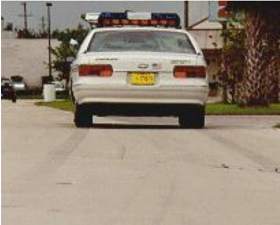
En la presente toma fotográfica pueden apreciarse las huellas dejadas sobre el pavimento por una unidad equipada con ABS. Lo precedente permite derribar en forma categórica el mito instalado entre muchos reconstructores de accidentes referente a que, si el rodado contaba con ABS no pudo dejar marcas sobre la calzada.
