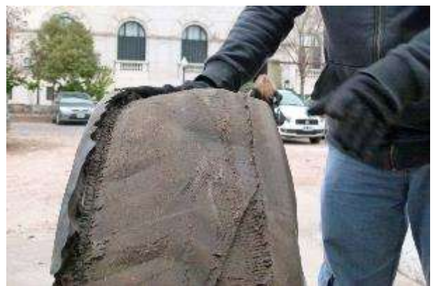
Cubierta colapsada 8.30 (200 km después)
