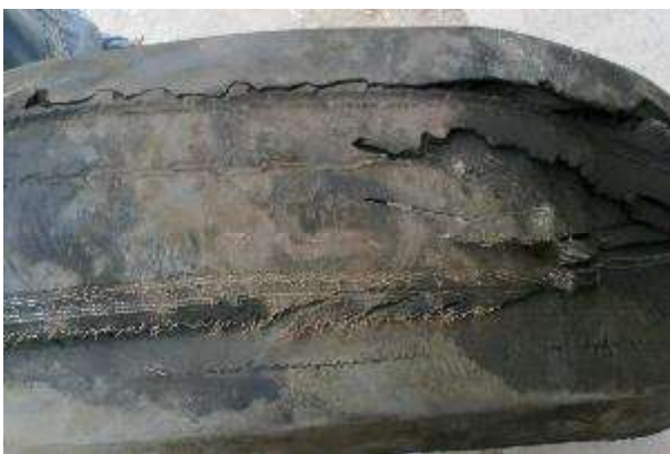
Cubierta colapsada a las 6.00 hs
